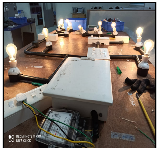
1BHK wiring practical
